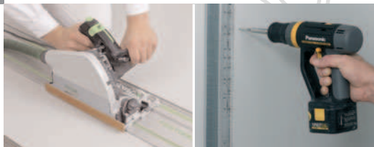
Scie circulaire lame de carbure Vis spéciales anti-corrosion pour la découpe de la plaque
